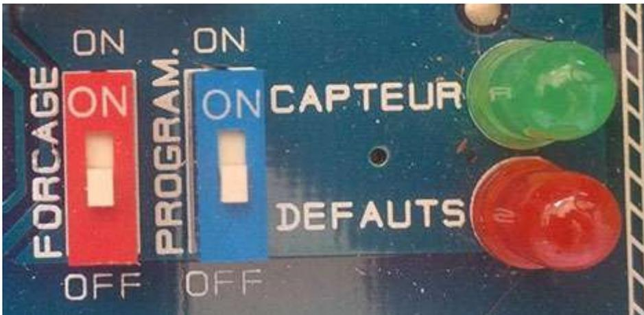
1. Mettre le volet en position enroulé. Utilisez le mode forçage si nécessaire : Mettre le mini-interrupteur rouge sur ON
