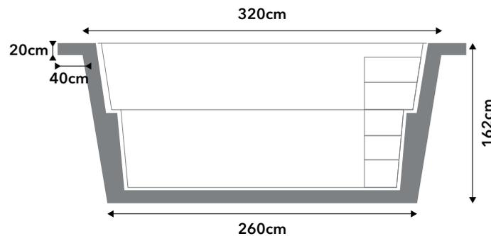
⚠ **Utiliser du stabilisé 250kg/m<sup>3</sup>**
