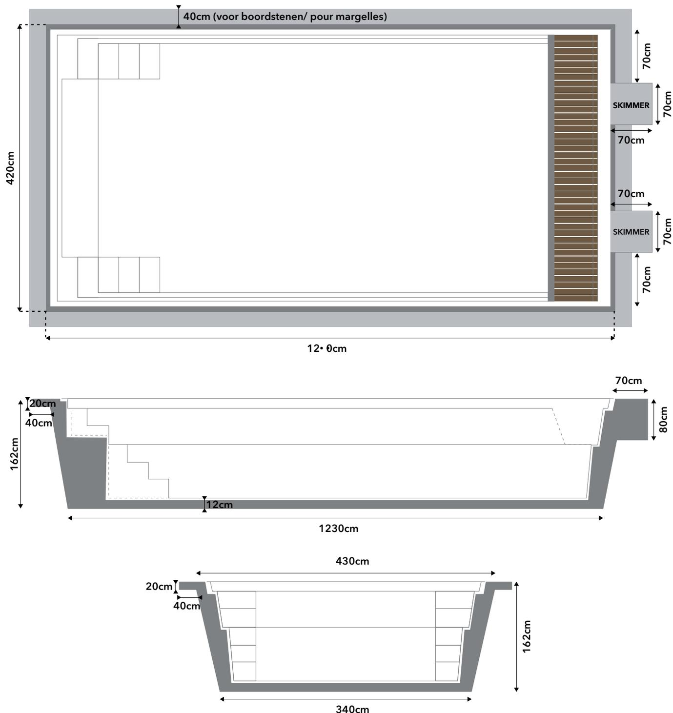
**⚠ Utiliser du stabilisé 250kg/m<sup>3</sup>**
